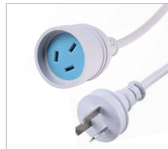
PSB-10/PSB-10Z 16A 250V~ MAX4000W 60227IEC53 3x1.5mm 2 60245IEC53 3x2.5mm 2
