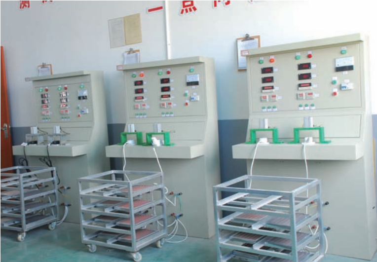
漏保成品寿命试验设备
