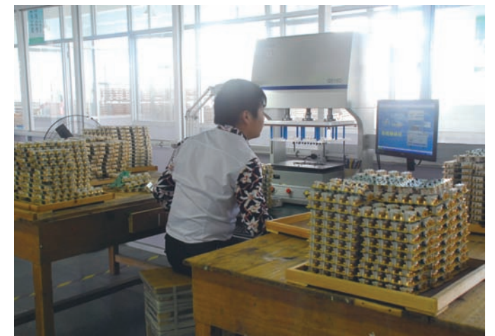
漏保线路板检测
